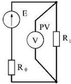
3. Какое напряжение показывает вольтметр PV, если  $E=12\text{ В}$ ,  $R_0=1\text{ Ом}$ ,  $R_1=11\text{ Ом}$ ?
