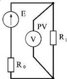
4. Какое напряжение показывает вольтметр PV, если  $E=20\text{ В}$ ,  $R_0=2\text{ Ом}$ ,  $R_1=18\text{ Ом}$ ?
