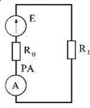
8. Какой ток показывает амперметр PA, если  $E=2$  В,  $R_0=1$  Ома,  $R_1=9$  Ом?
