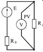
1. Какое напряжение показывает вольтметр PV, если  $E=12\text{ В}$ ,  $R_0=2\text{ Ом}$ ,  $R_1=10\text{ Ом}$ ?
