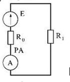
6. Какой ток показывает амперметр PA, если  $E=12\text{ В}$ ,  $R_0=2\text{ Ом}$ ,  $R_1=10\text{ Ом}$ ?
