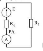
7. Какой ток показывает амперметр PA, если  $E=12\text{ В}$ ,  $R_0=2\text{ Ом}$ ,  $R_1=4\text{ Ом}$ ?
