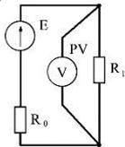
2. Какое напряжение показывает вольтметр PV, если  $E=12\text{ В}$ ,  $R_0=4\text{ Ом}$ ,  $R_1=8\text{ Ом}$ ?
