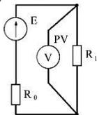
5. Какое напряжение показывает вольтметр PV, если  $E=15\text{ В}$ ,  $R_0=2\text{ Ом}$ ,  $R_1=13\text{ Ом}$ ?
