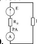
10. Какой ток показывает амперметр PA, если  $E=80$  В,  $R_0=2$  Ома,  $R_1=8$  Ом?
