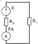
9. Какой ток показывает амперметр PA, если  $E=120$  В,  $R_0=2$  Ома,  $R_1=10$  Ом?
